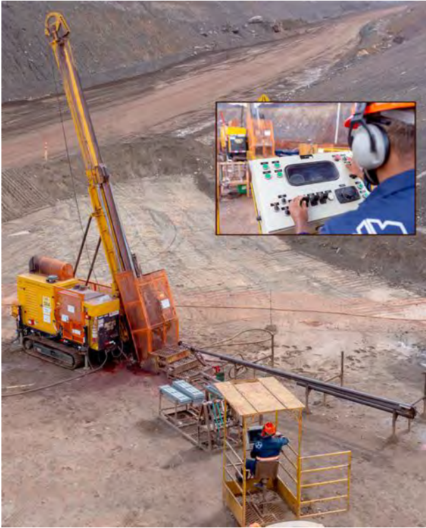
Operação remota de sonda: sem riscos ao operador
