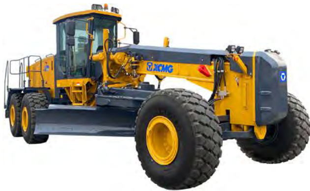
Motoniveladora GR3505, da XCMG
