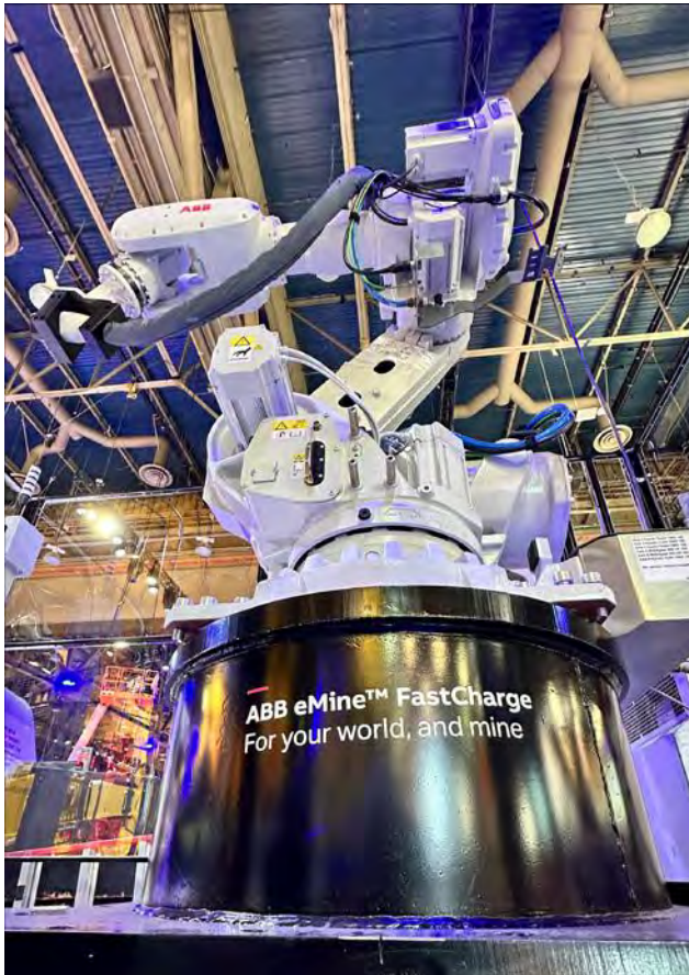
Robô industrial da ABB criado para automatizar a recarga de caminhões
